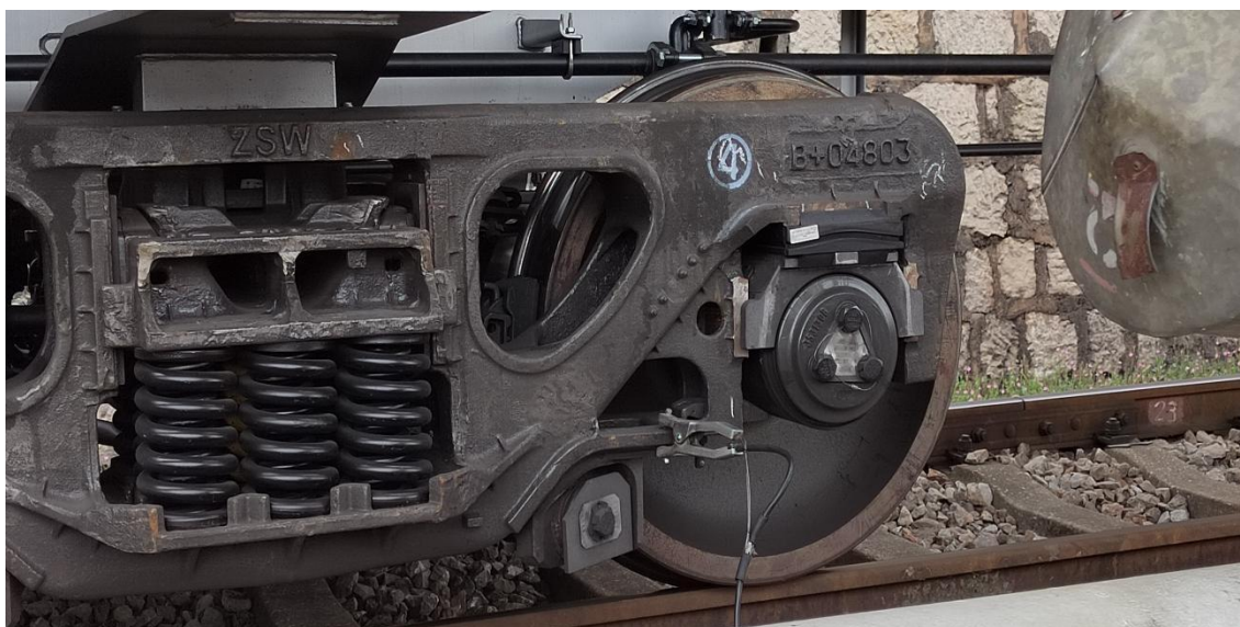
图 2-5 栈桥下设有罐车接地接地夹
